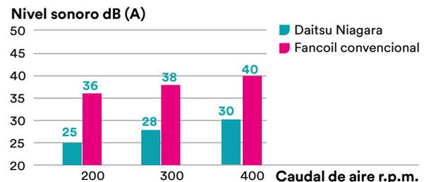
La unidad Niagara Ultra Slim con velocidad de ventilador baja tiene un funcionamiento estable y una vibración muy baja, además puede funcionar a un mínimo de RPM mediante el preajuste de velocidad.
