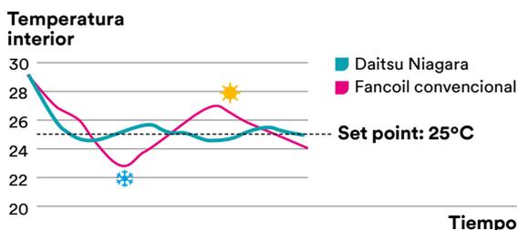
El ajuste de velocidad variable maximiza el confort gracias a una muy rápida respuesta de la temperatura interior y una flecha de aire optimizada.
